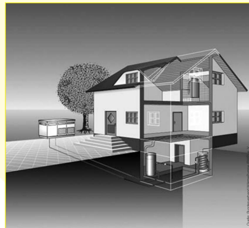
Prinzipielle Darstellung der Funktionsweise einer Luft-Warmwasser-Wärmepumpe
